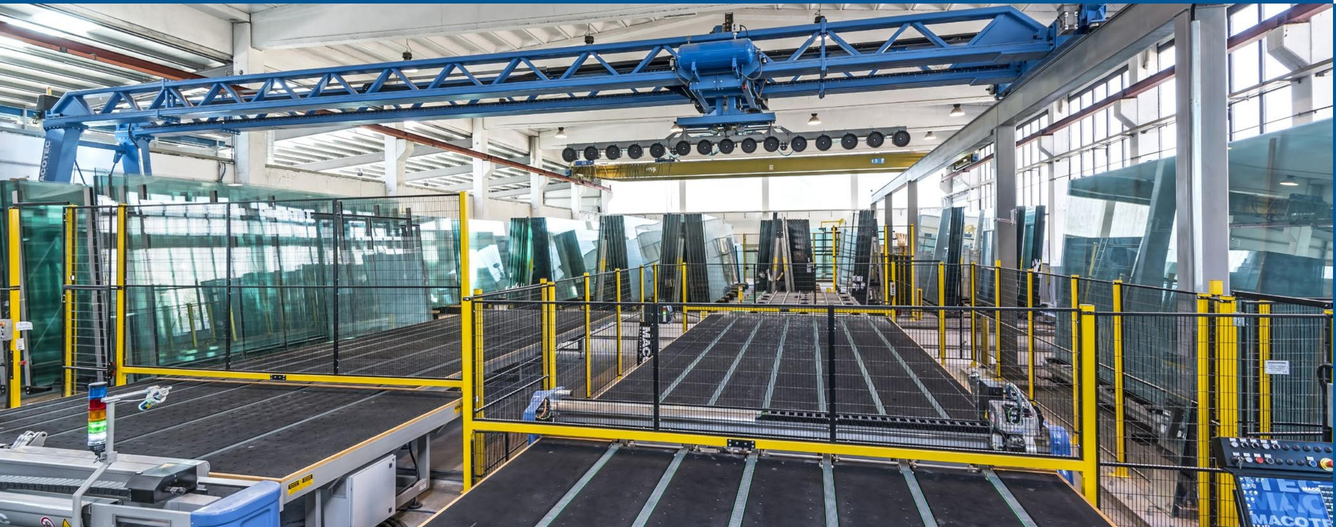
■ Carroponte automatico per il prelievo delle lastre di vetro, da cavalletti verticali fissi o da classificatori, e per il loro trasferimento alle linee da taglio caratterizzato dall'innovativa combinazione di tre importanti funzionalità:
