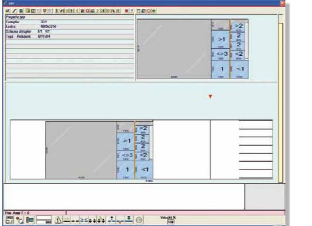
■ Ottimizzatore installato a bordo macchina, con visualizzazione grafica delle diverse fasi di lavorazione.
