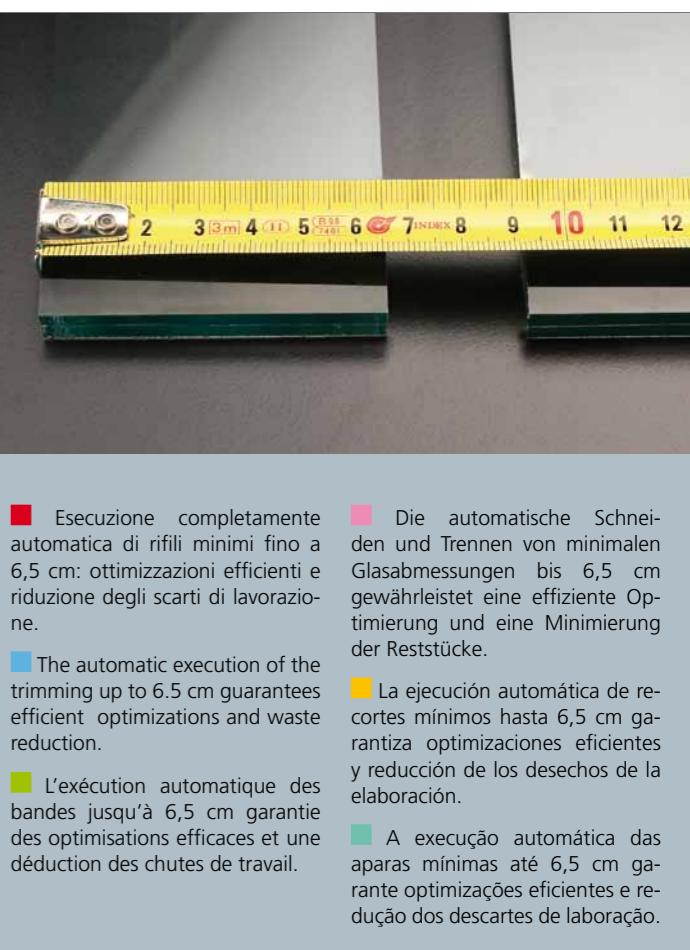
■ Esecuzione completamente automatica di rifili minimi fino a 6,5 cm: ottimizzazioni efficienti e riduzione degli scarti di lavorazione.
